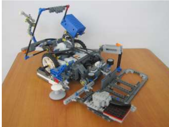
Fig. 3. Diseño del robot de competencias con piezas LEGO MINDSTORMS NXT 9797.
