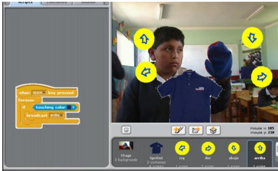
Figura N° 02. Probador de ropa virtual con detección de color
