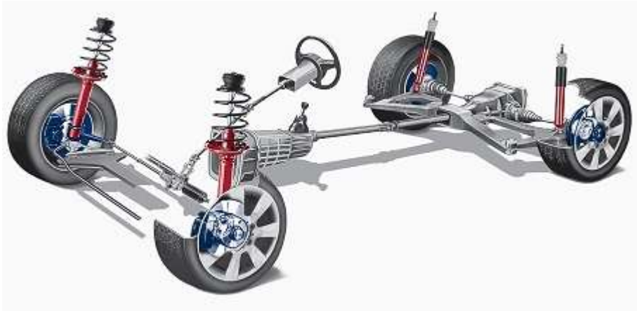
Figura 5. Función de los amortiguadores: (KYB, 2009)
