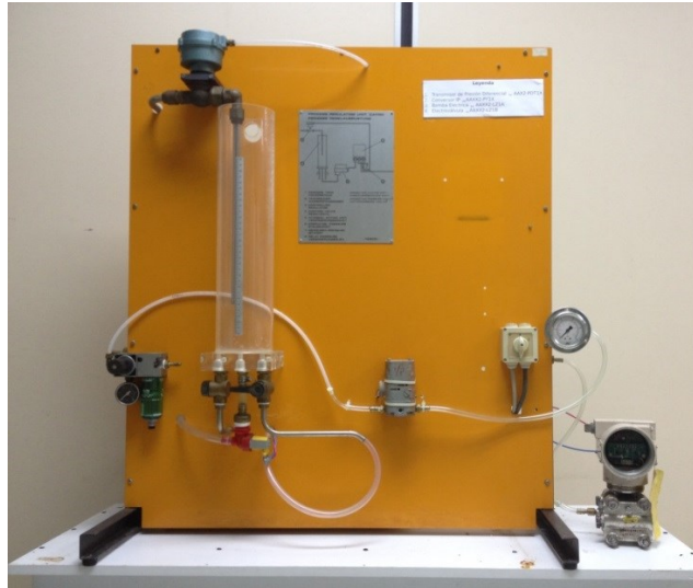
Figura 11. Vista Frontal de la Maqueta Didáctica de Medición de Nivel con Transmisor de Presión Diferencial luego de ser modificada
