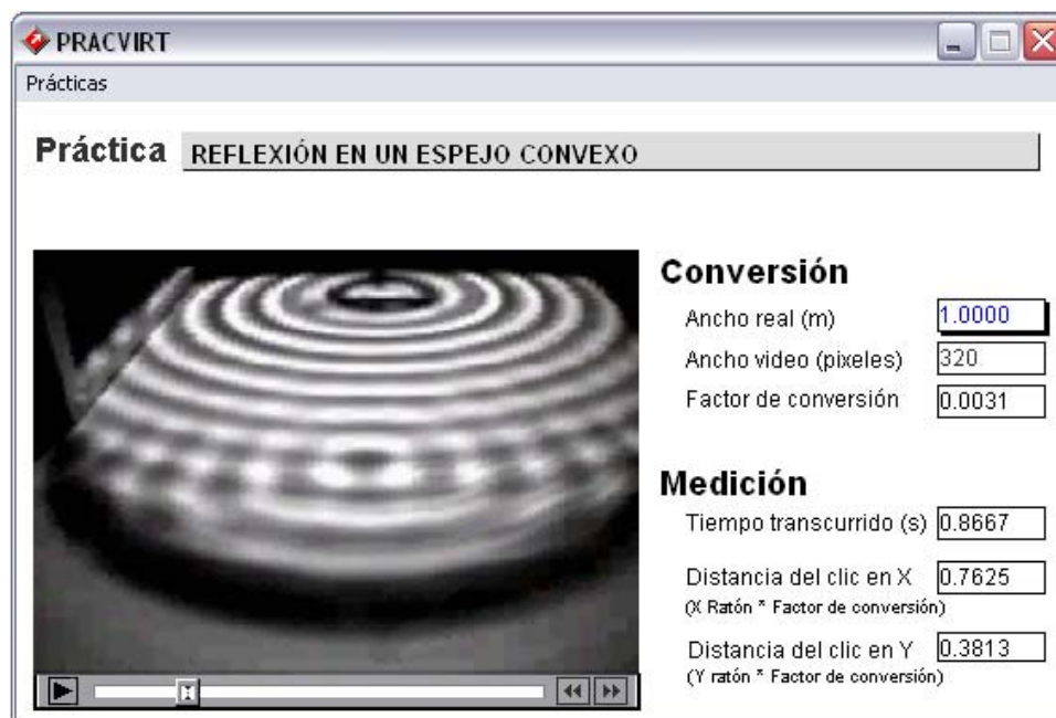
Fig. 4 Pantalla del experimento del laboratorio virtual de óptica: reflexión en un espejo convexo.
