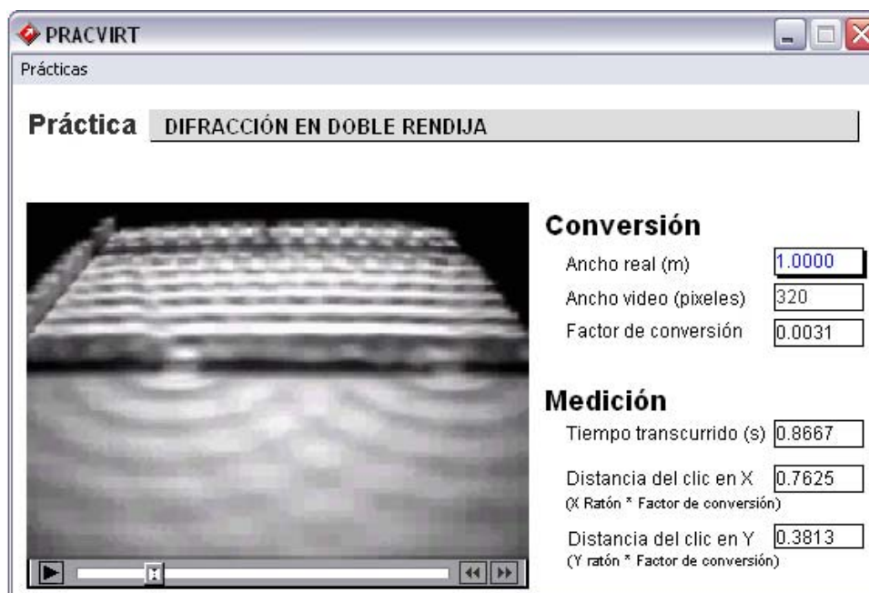
Fig. 3 Pantalla del experimento del laboratorio virtual de óptica: difracción en doble rendija.
