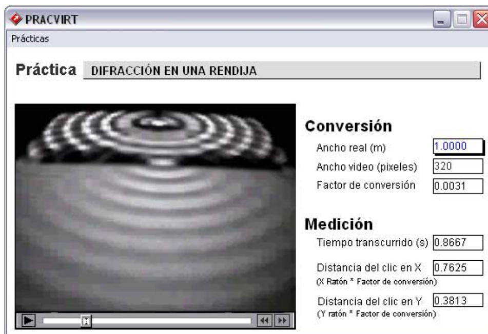
Fig. 2 Pantalla del experimento del laboratorio virtual de óptica: difracción en una rendija.
