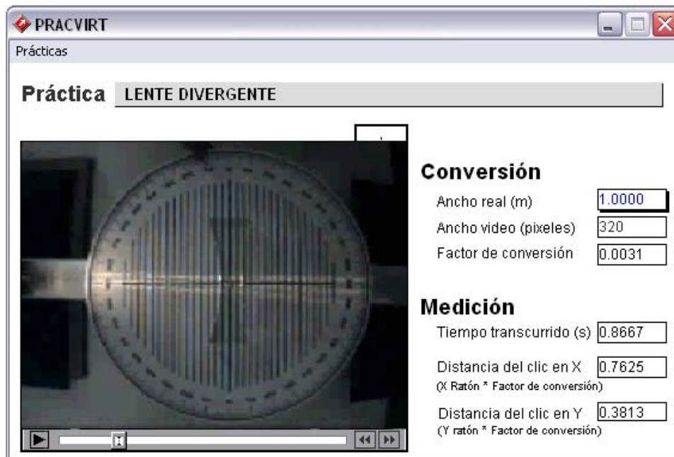
Fig. 6 Pantalla del experimento del laboratorio virtual de óptica: lente divergente.
