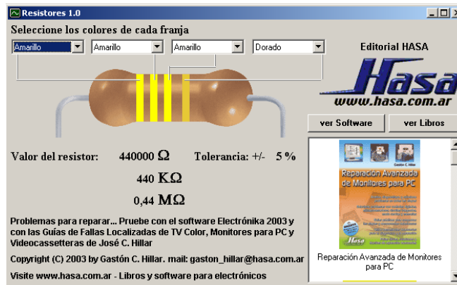
Figura 6 PROGRAMA PARA CALCULAR EL VALOR DEL RESISTOR
