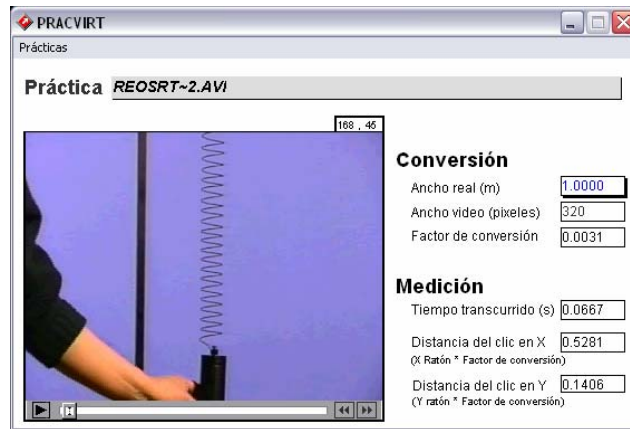
Figura 9. Experimento basado en video de una masa suspendida de un resorte.
