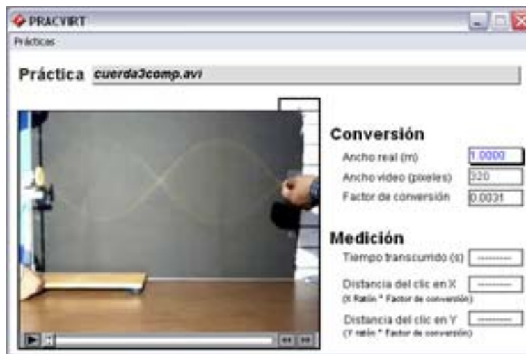
Figura 9. Experimento basado en video de ondas estacionarias en una cuerda con otras condiciones.
