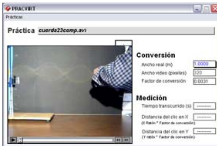
Figura 9. Experimento basado en video de ondas estacionarias en una cuerda.
