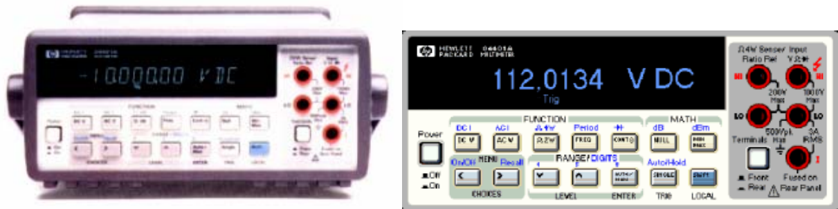
Figura 1: Multímetro digital real y su homólogo virtual
